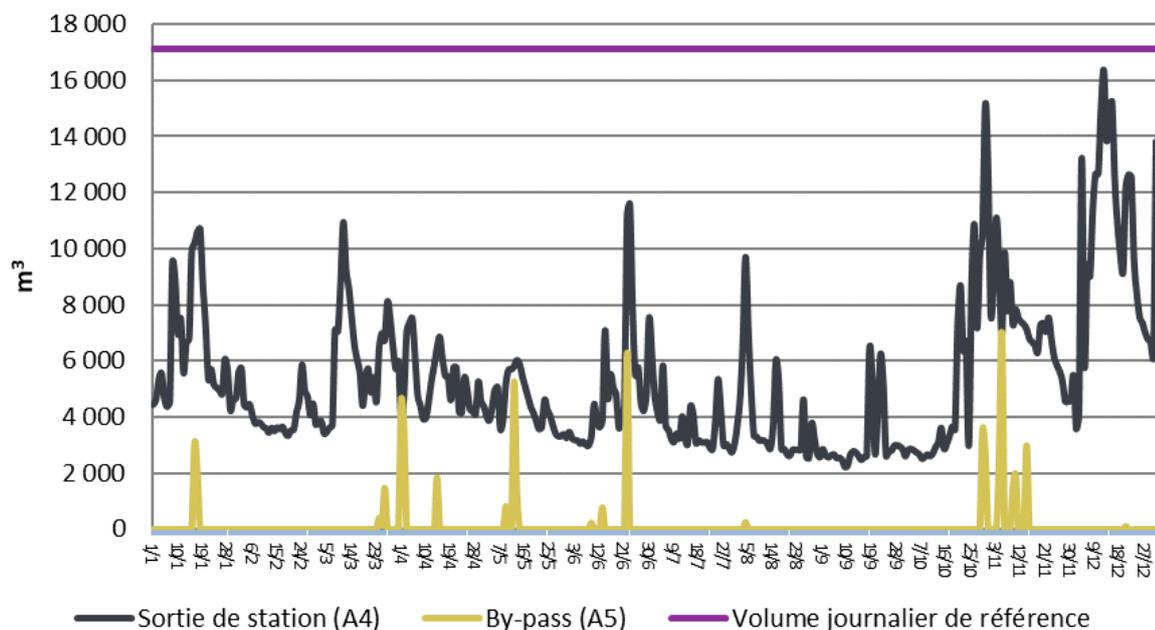
Le volume total annuel d'effluents traités sortant de la station (A4) est de 1 964 530 m<sup>3</sup>. Il y a eu 54 407 m<sup>3</sup> d'eaux prétraitées déversées au niveau du by-pass du bassin tampon (A5).
